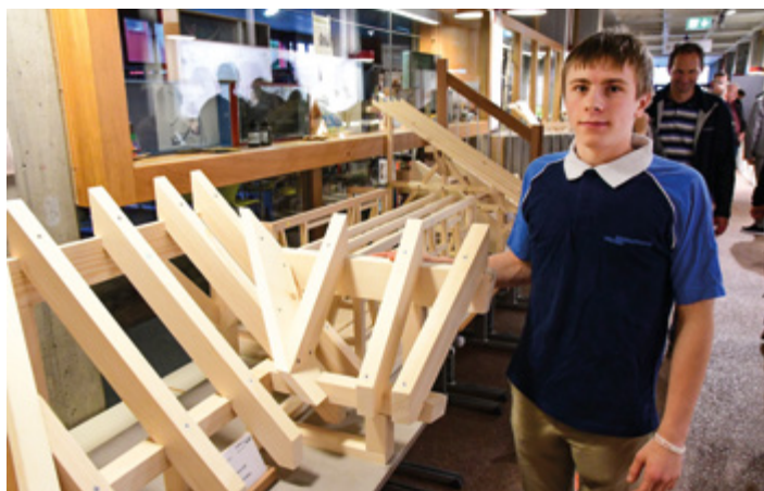
Manuel Hofer vor seinem Modell eines Walmdachs mit Gratsparren und Kehlblech.
