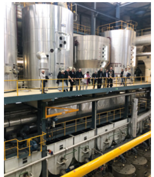
Im Zuckerhaus wird der filtrierte und gereinigte Dünnsaft mit 15% Trockensubstanzgehalt in der Verdampfstation zu Dicksaft mit einem Trockengehalt von 70% eingedickt.
