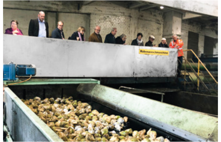
Die Mentoren beim Werkrundgang: An dieser Stelle werden die Rüben gewaschen und zu Schnitzeln zerkleinert.
