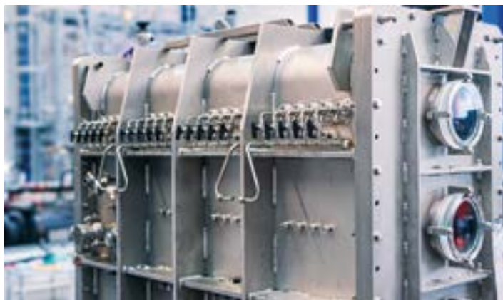
Erstellung des Herzstücks des Prototyps eines Sorptionswärmespeichers SeasON. Dessen Installation erfolgt im Rahmen eines Pilot- und Demonstrationsprojekts bei der Tierkörpersammelstelle in Frauenfeld.
