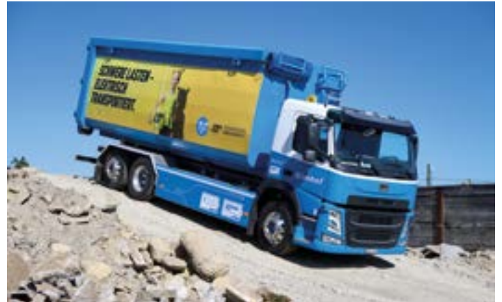
Soll Emissionen senken: Der neue vollelektrische Hakenabroll-Kipper der TIT Imhof AG. Bild: TIT Imhof AG
